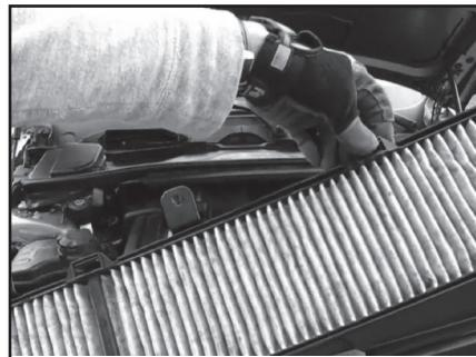
**Lugar del filtro:** Debajo del capó en la parte delantera y central del parabrisas, debajo de la tapa del filtro de cabina.
