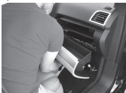
**Emplacement du filtre :** Sur le côté passager du véhicule derrière la boîte à gants.
